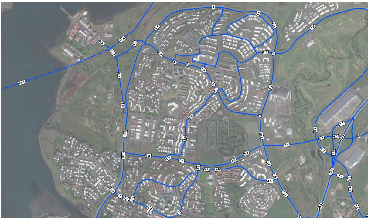
Mynd 5.8 Niðurstaða spár 2030 fyrir Sundabraut í göngum, nærmynd fyrir Grafarvog. Sjá má að tæplega 18.000 bílar (HVDU) skiptast á tengingar til suðurs og norðurs. Gert er ráð fyrir mislægum gatnamótum við Sundabraut þó þau séu ekki sýnd í mynd.
